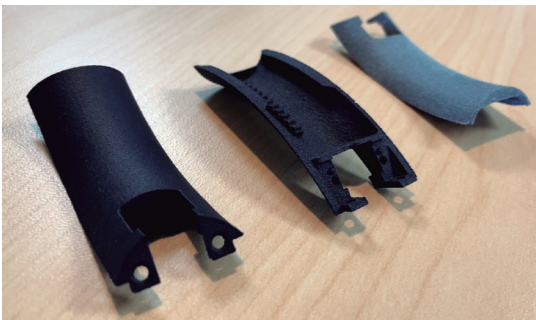
Piezas fabricadas para Central Sound, recién impresas (gris) y después de teñidas (negro).
